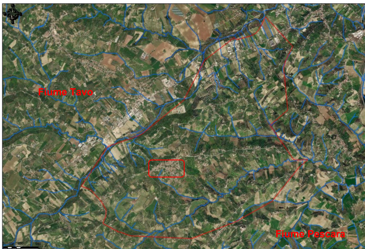
Figura 39 - Schema delle linee di drenaggio superficiale nell'area di Moscufo.
